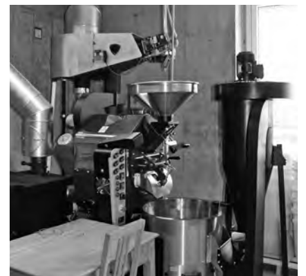
Die Kaffeeröstmaschine ist für eine Produktion von jährlich 50 Tonnen Bohnen ausgelegt. Zur Zeit röstet Fabrizio Keller jährlich rund zehn Tonnen.
